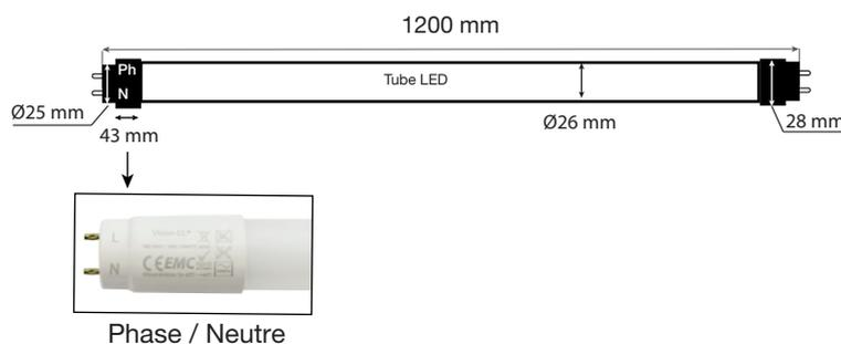
**Fonctionne aussi avec support avec ballast ferromagnétique si le starter fourni avec notre tube est installé**
