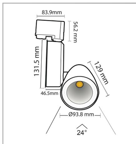
Produit : Spot LED COB sur rail + adaptateur rail 3 allumages
